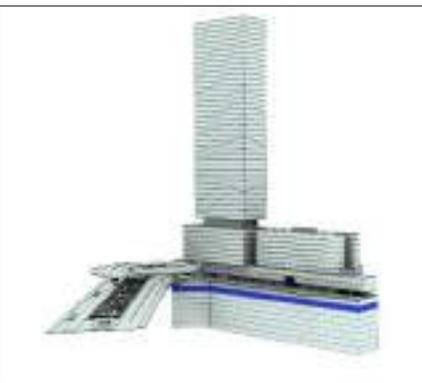
El sótano -2 se encuentra 10.65 m bajo el nivel de la calle y cuenta con dos alturas, la primera con una altura de piso terminado a piso terminado de 5.50 m y la segunda con una altura de 6.65 m. Este nivel será destinado para el ATM norte. Se utilizan áreas residuales para áreas de servicio de la Torre B y Torre A, las cuales ocuparán un área de **608.25 m<sup>2</sup>**.
