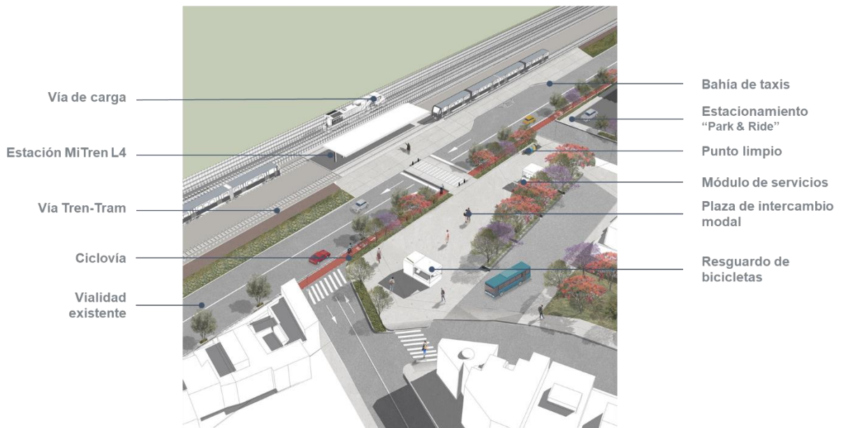
Figura 2.13. Conceptualización de las estaciones de la Línea 4 (componentes de estación)
