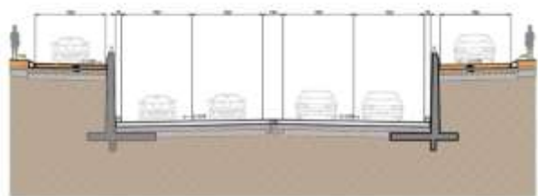
Sección vial estructura inferior y carriles a nivel del Nodo Las Juntas
