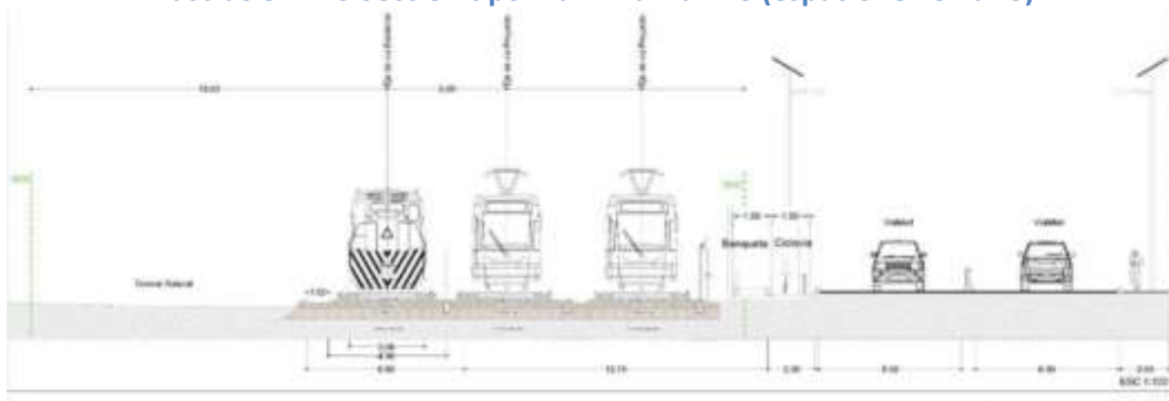
Ilustración 123 Sección tipo Vía 1 Manzanillo (espacio ferroviario)
