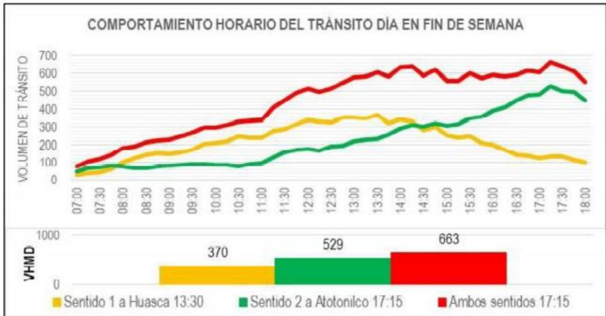
Figura 20. Aforo Manual Estación 06
