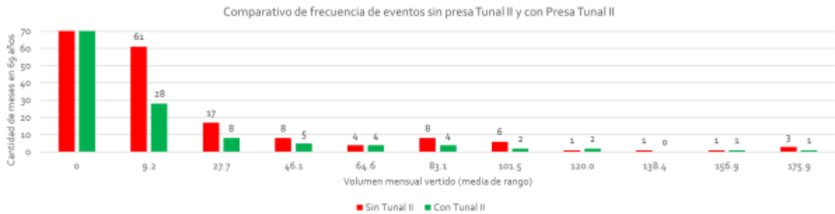
Figura 3. Comparativo de frecuencia de eventos de distinta magnitud de volumen vertido, con y sin presa Tunal II.
