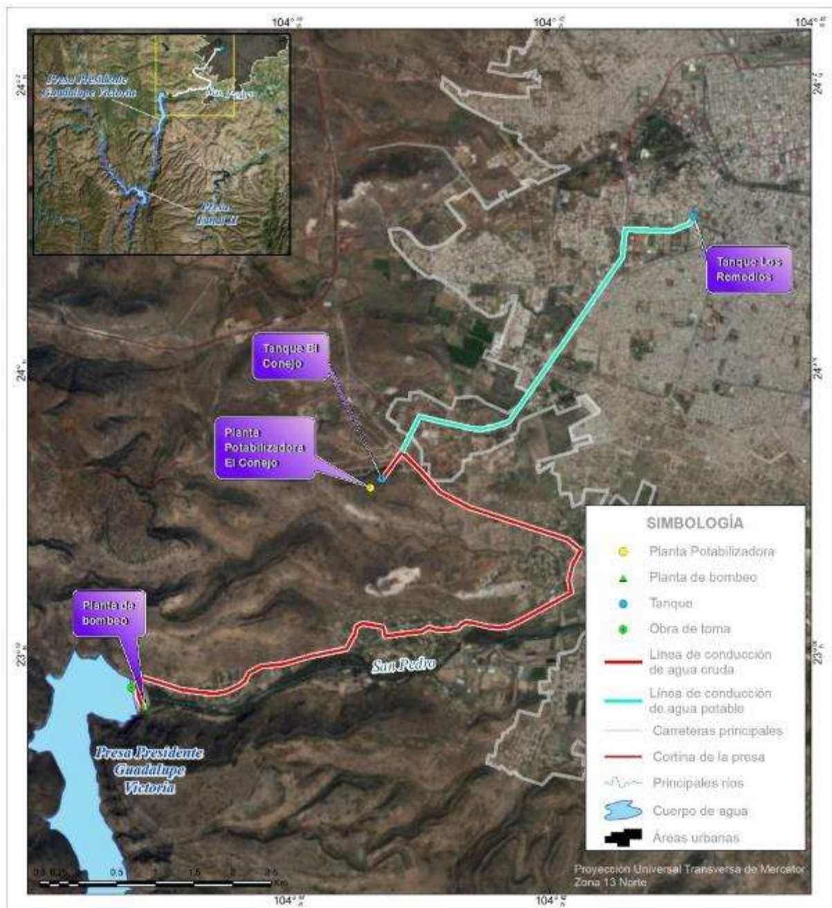
Figura 19. Presa Tunal II y obras complementarias
