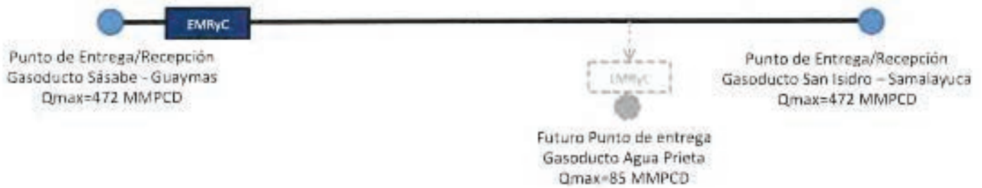
FIGURA 1 Diagrama Esquemático de Sistema Samalayuca - Sásabe
